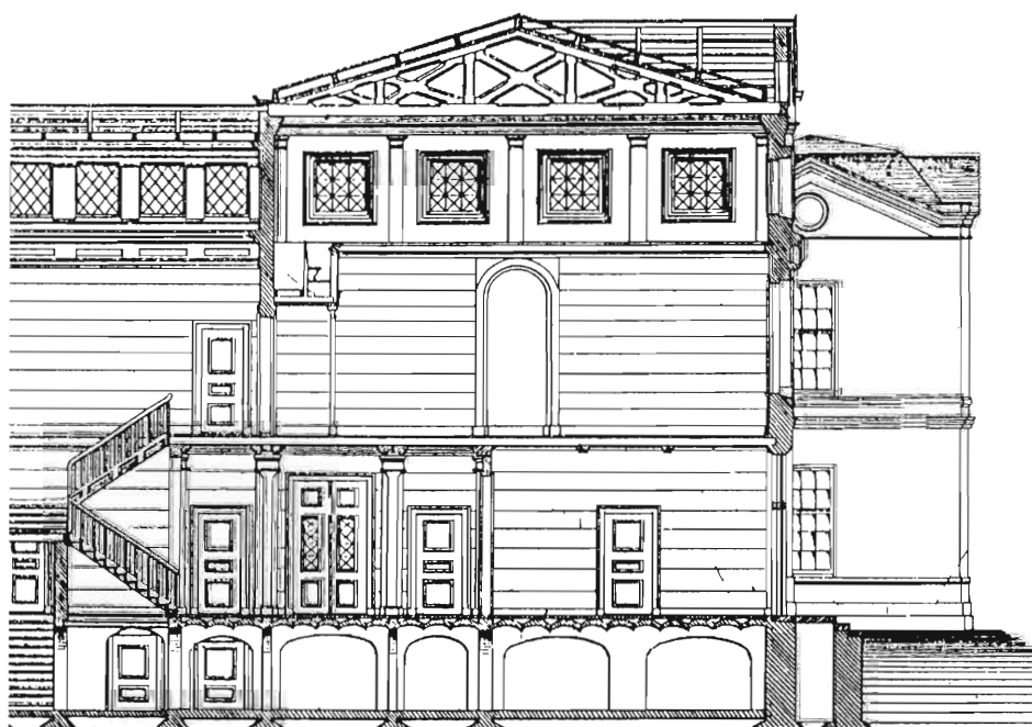
Doorsnede over de kerkzaal. Oorspronkelijke bouwtekening (GA).
